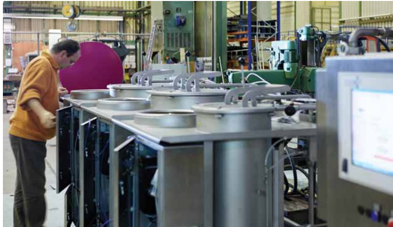
Automatische Dosierstation von Farbstoffen: die Farbe wird gemischt und auf Abruf über ein Leitungssystem zur Maschine gepumpt.
