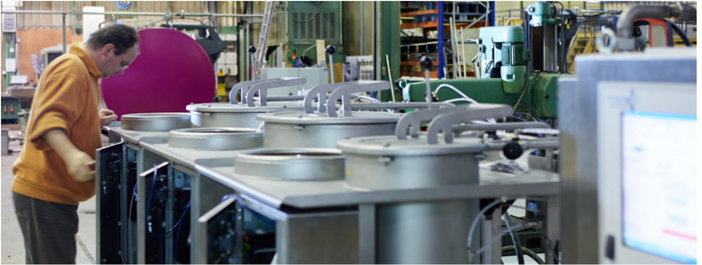
Automatische Dosierstation von Farbstoffen: die Farbe wird gemischt und auf Abruf über ein Leitungssystem zur Maschine gepumpt.
